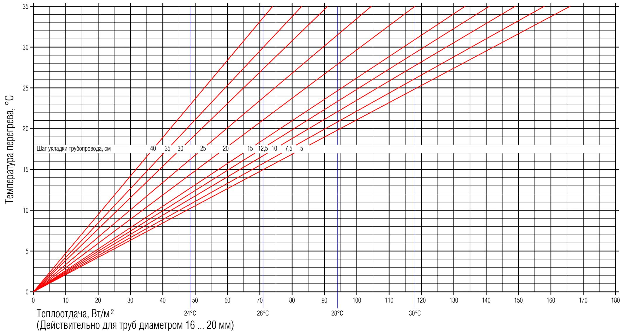
**Диаграмма 4.** Тепловая нагрузка для сопротивления теплопередаче настила пола  $R_{\text{ЛВ}} = 0,1 \text{ м}^2 \cdot \text{°C}/\text{Вт}$
