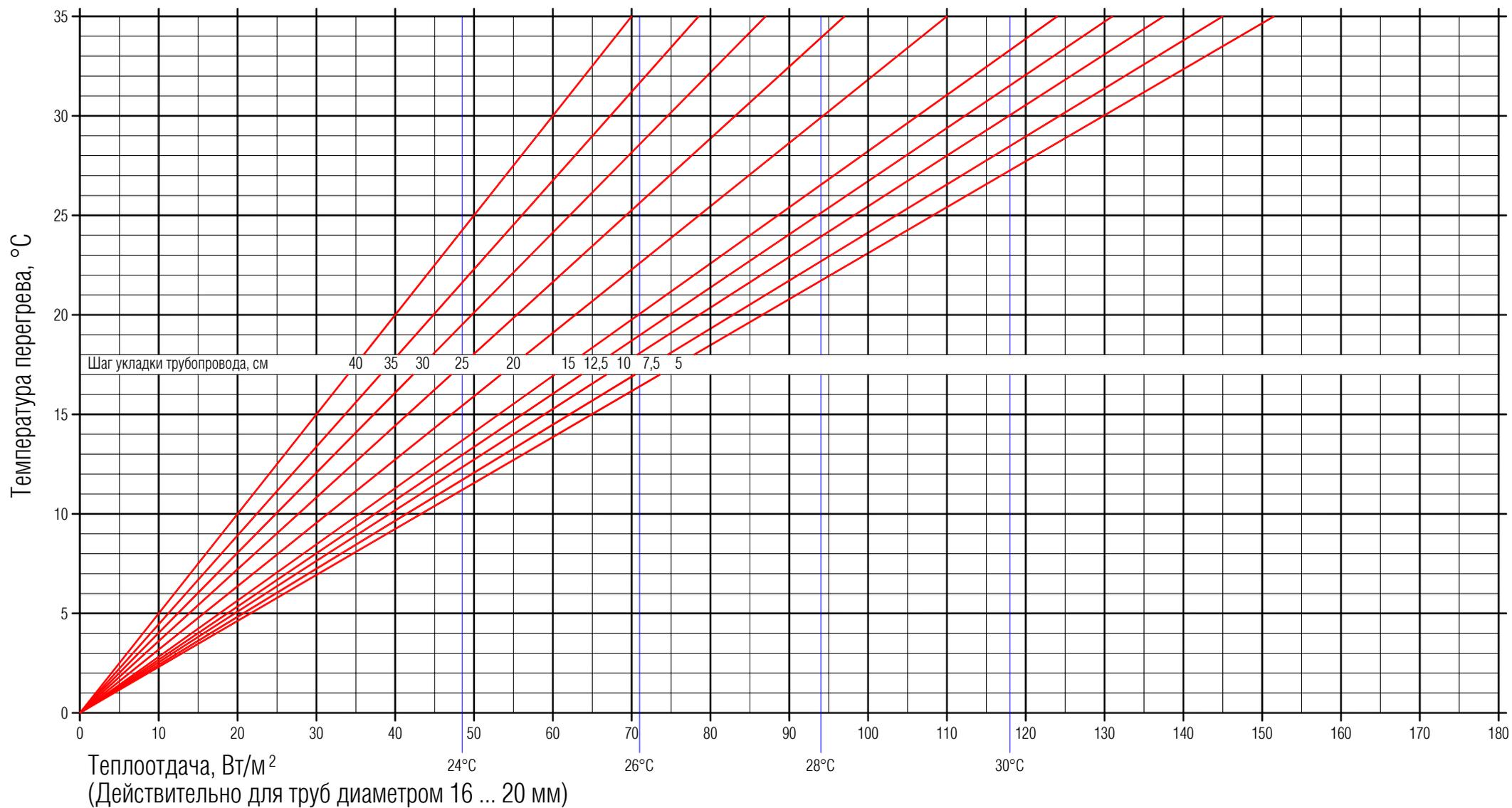
**Диаграмма 5.** Тепловая нагрузка для сопротивления теплопередаче настила пола  $R_{\text{ЛВ}} = 0,12 \text{ м}^2 \cdot \text{°C}/\text{Вт}$
