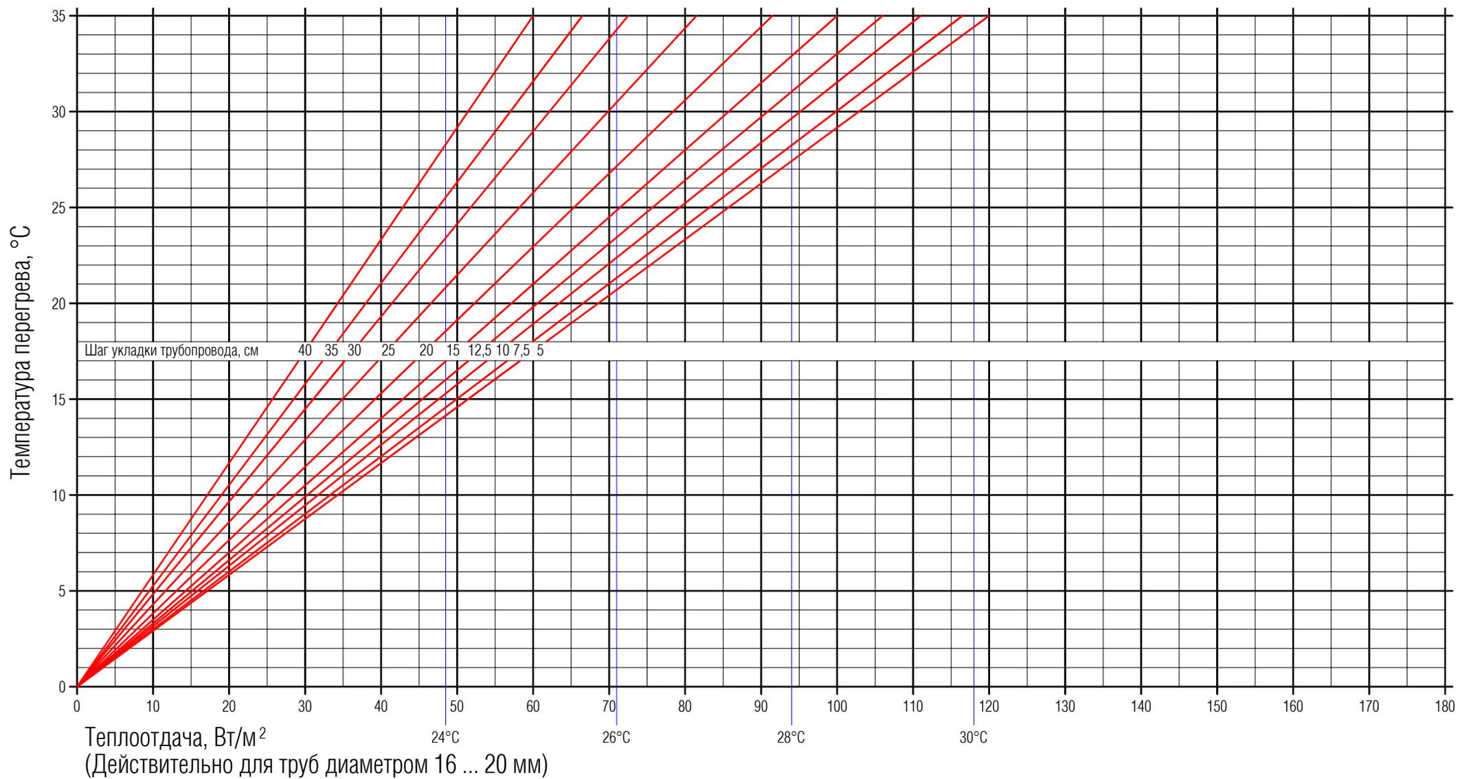
**Диаграмма 9.** Тепловая нагрузка для сопротивления теплопередаче настила пола  $R_{\text{ЛВ}} = 0,20 \text{ м}^2 \cdot \text{°C}/\text{Вт}$
