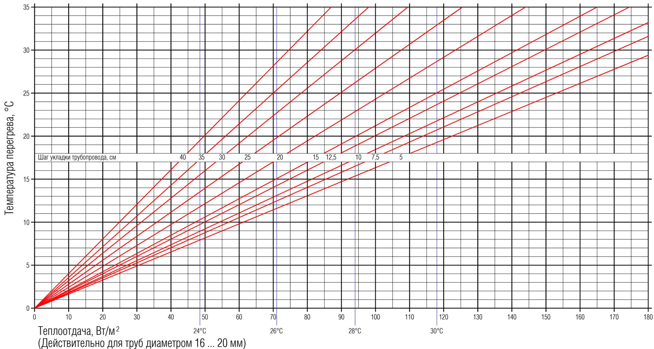
**Диаграмма 2.** Тепловая нагрузка для сопротивления теплопередаче настила пола  $R_{\Delta B} = 0,05 \text{ м}^2 \cdot \text{°C}/\text{Вт}$
