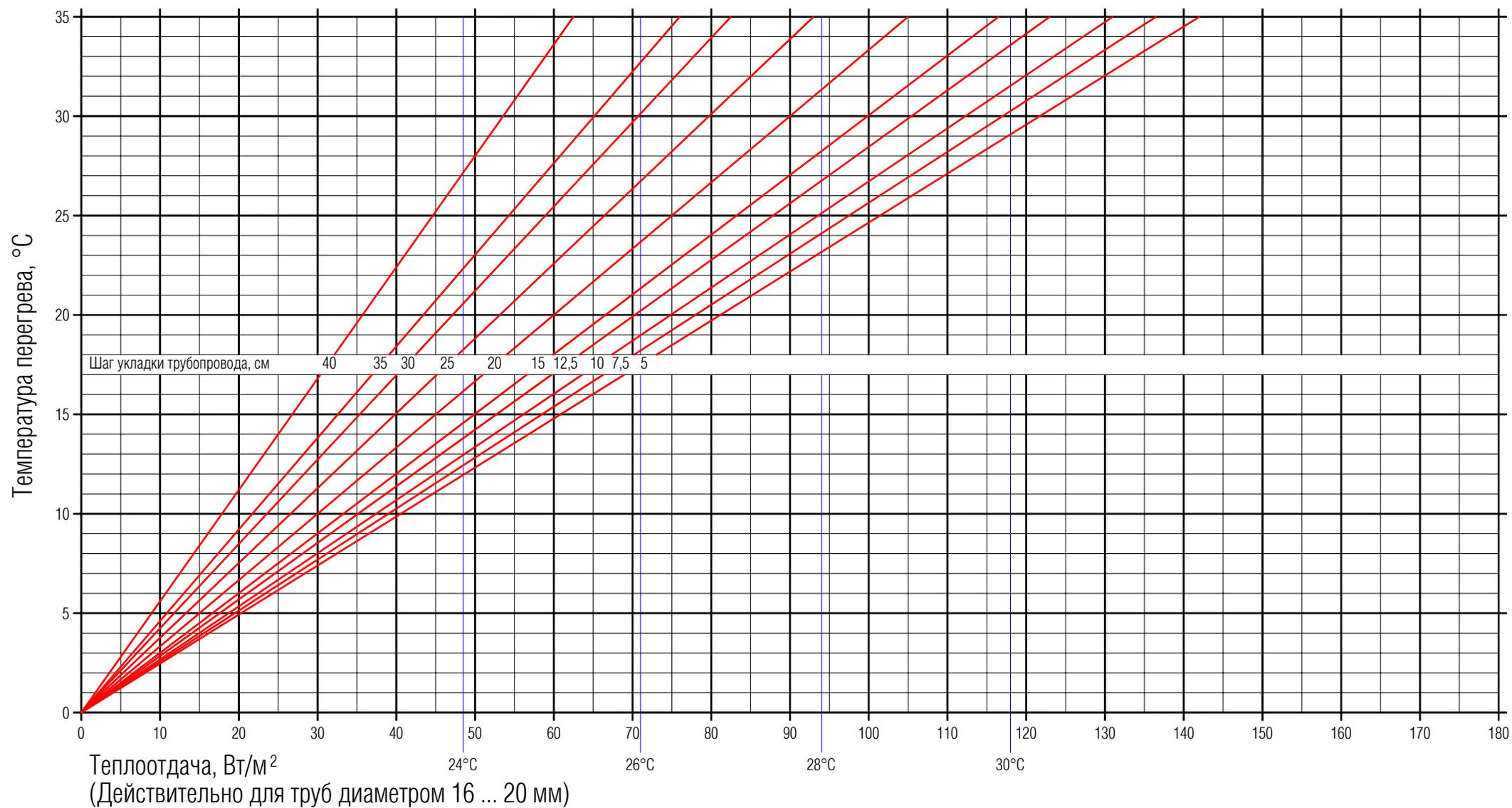
**Диаграмма 6.** Тепловая нагрузка для сопротивления теплопередаче настила пола  $R_{\text{ЛВ}} = 0,14 \text{ м}^2 \cdot \text{°C}/\text{Вт}$
