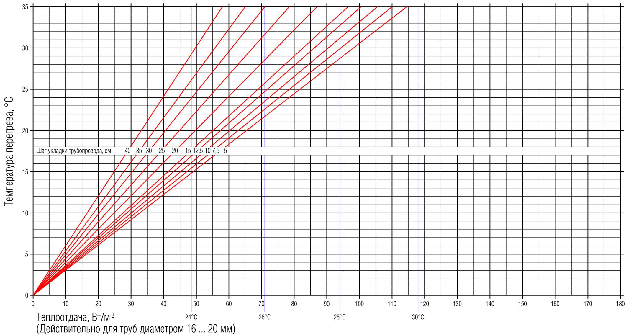
**Диаграмма 10.** Теплоотдача вниз пола для теплоизоляционного слоя 20 мм,  $\lambda = 0,04 \text{ Вт/м}\cdot^\circ\text{С}$
