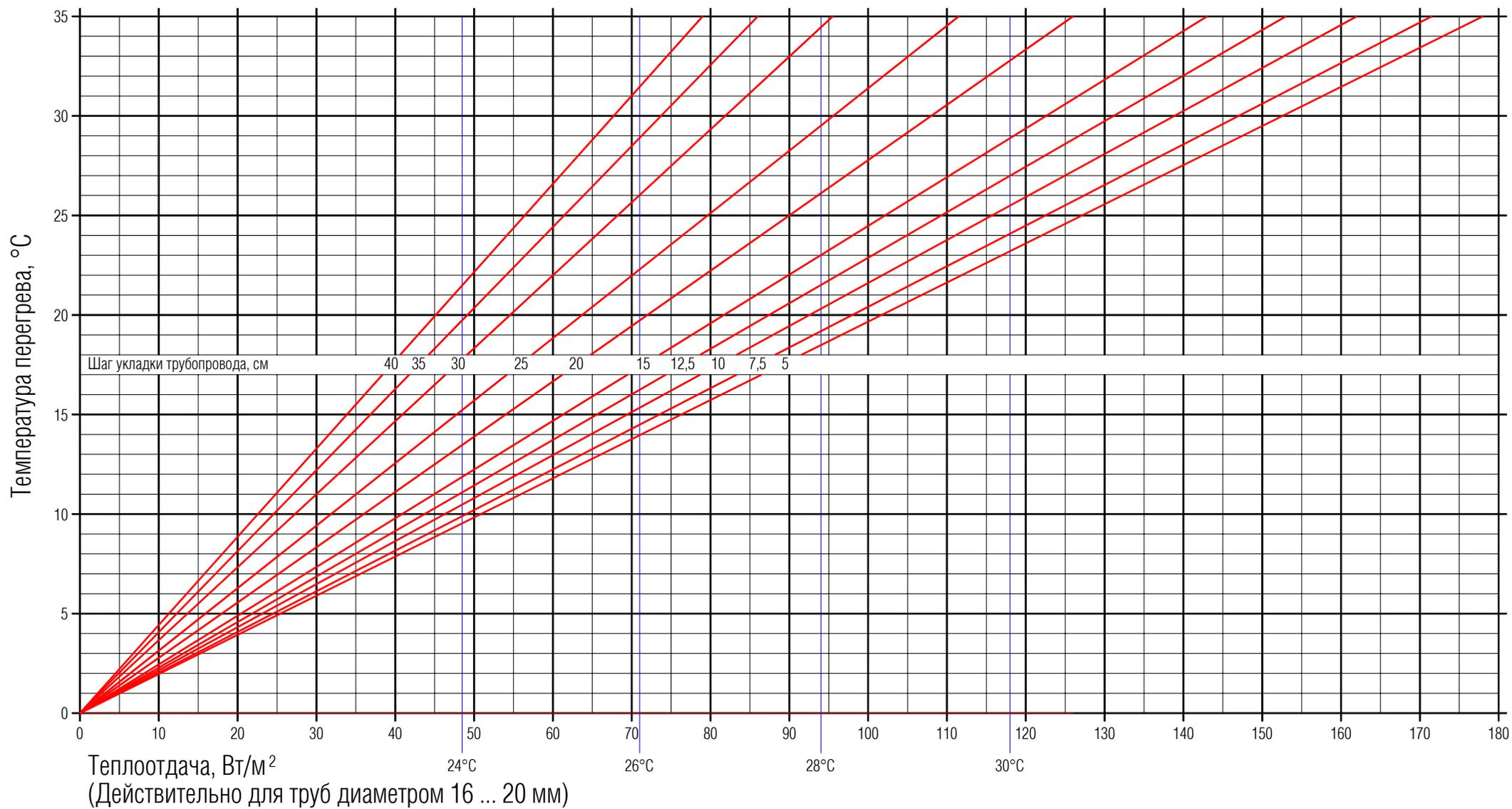
**Диаграмма 3.** Тепловая нагрузка для сопротивления теплопередаче настила пола  $R_{\text{ЛВ}} = 0,075 \text{ м}^2 \cdot \text{°C}/\text{Вт}$
