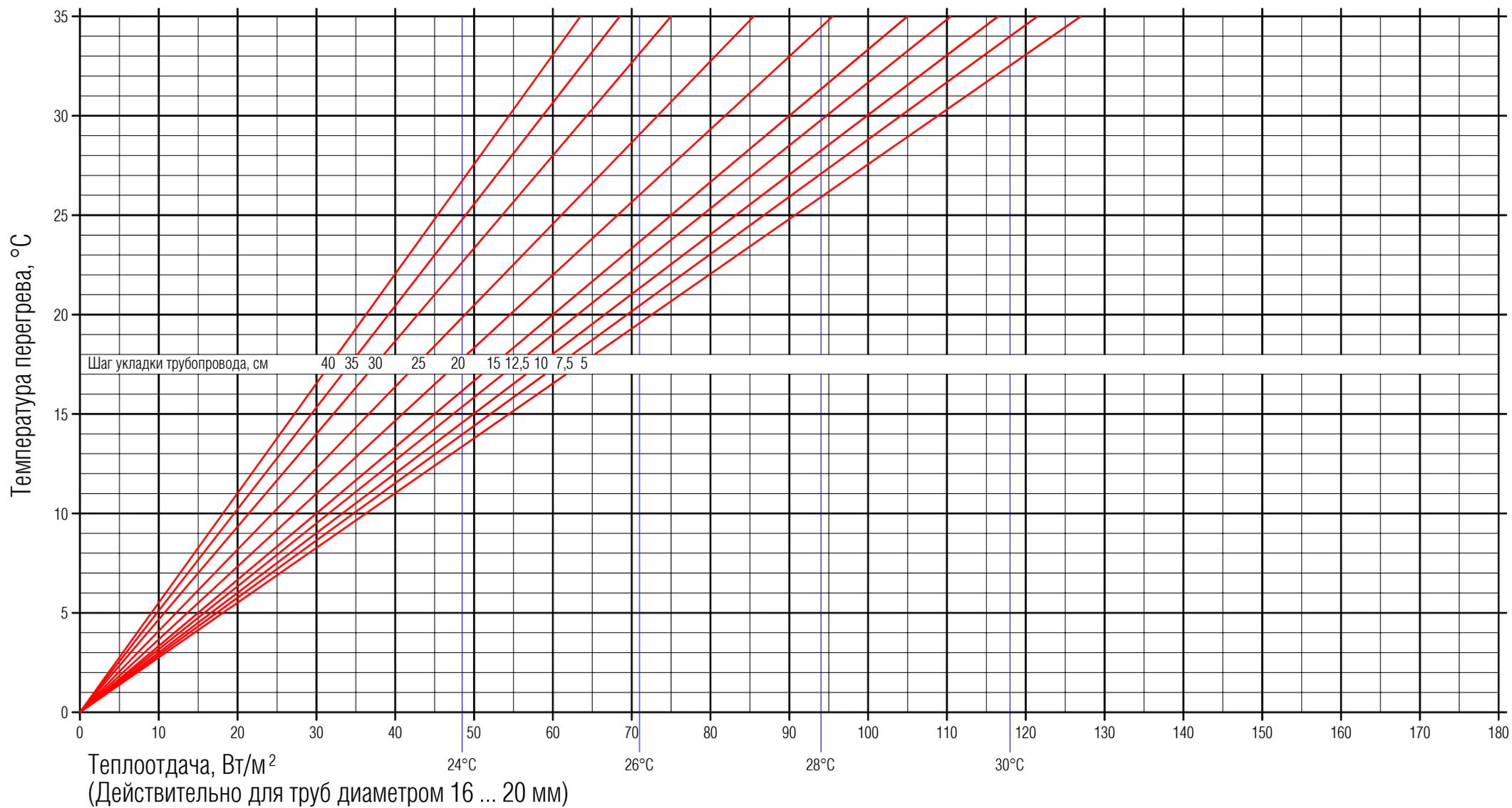
**Диаграмма 8.** Тепловая нагрузка для сопротивления теплопередаче настила пола  $R_{\text{ЛВ}} = 0,18 \text{ м}^2 \cdot \text{°C}/\text{Вт}$
