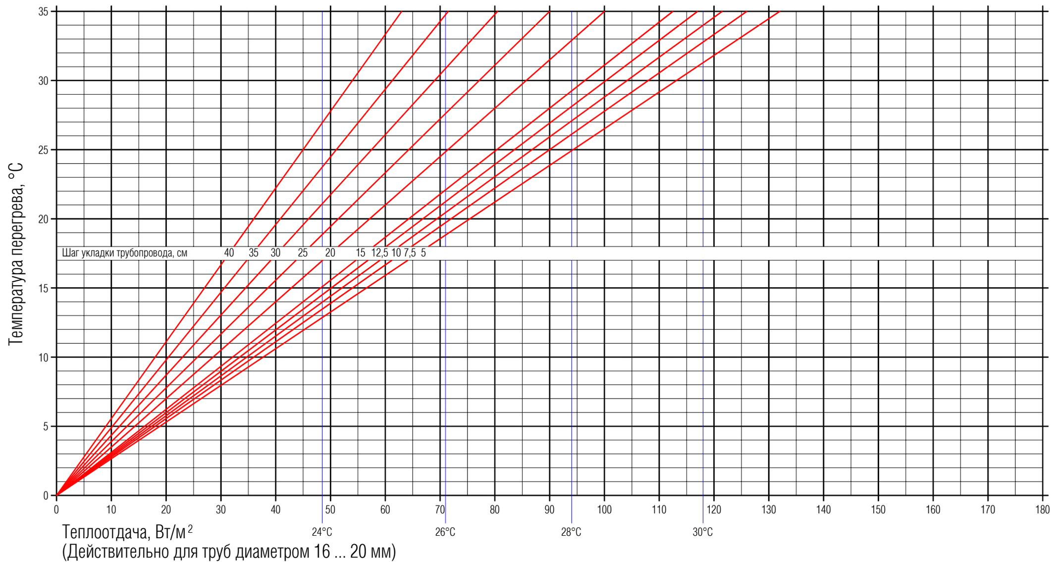
**Диаграмма 7.** Тепловая нагрузка для сопротивления теплопередаче настила пола  $R_{ЛВ} = 0,16 \text{ м}^2 \cdot \text{°C}/\text{Вт}$
